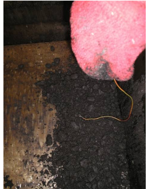
Figuur A4.10: Materiaal en thermodraden aanbrengen
