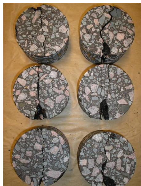
Figuur A4.32: Gespleten kernen
