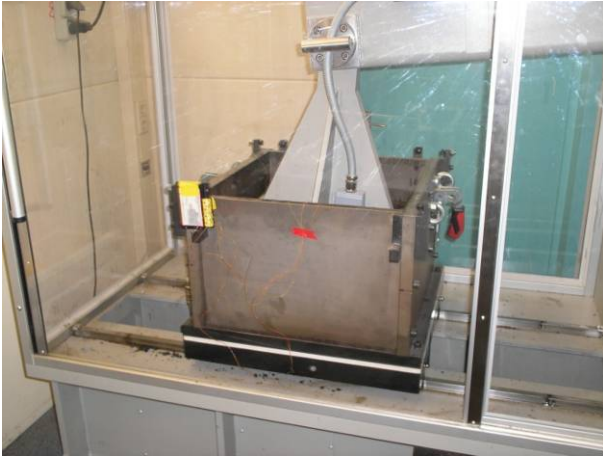
Figuur 3.15: Verdichten met de Freundl plaatverdichter
