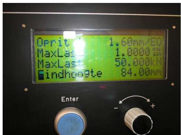
Figuur 3.14: Freundl plaatverdichter instellen
