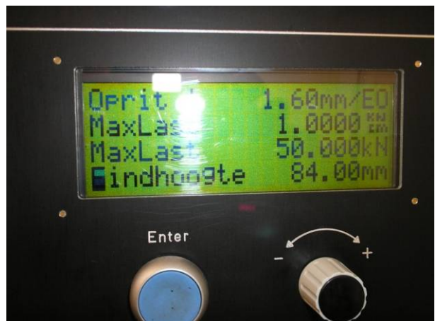
Figuur A4.14: Freundl plaatverdichter instellen
