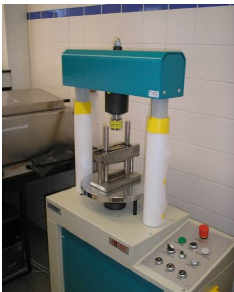
Figuur 3.31: Proefopstelling slijtproef
