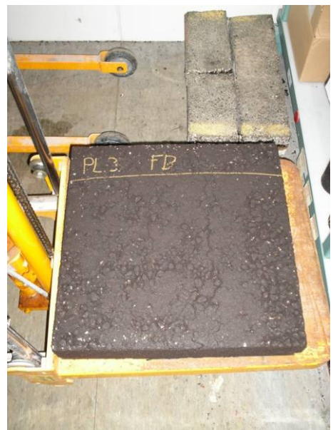
Figuur A4.20: Asfaltplaat zonder steunbak
