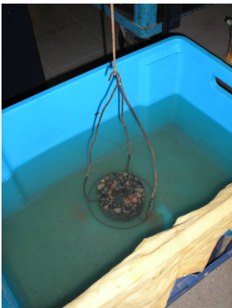
Figuur A4.25: Onder en boven water wegen
