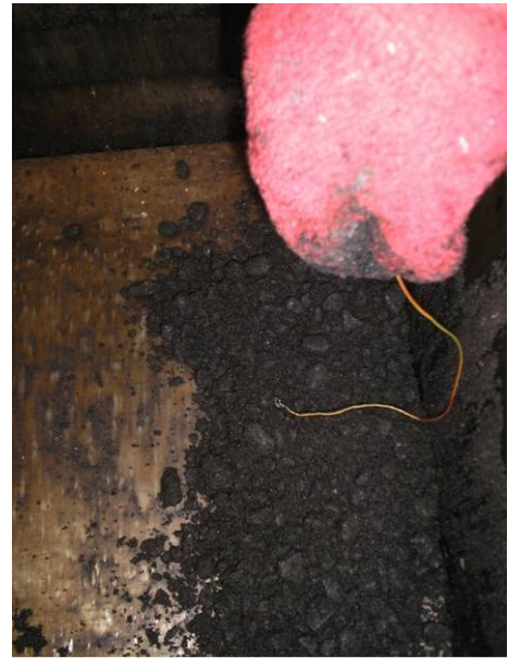
Figuur 3.10: Materiaal en thermodraden aanbrengen
