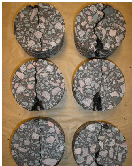
Figuur 3.32: Gespleten kernen
