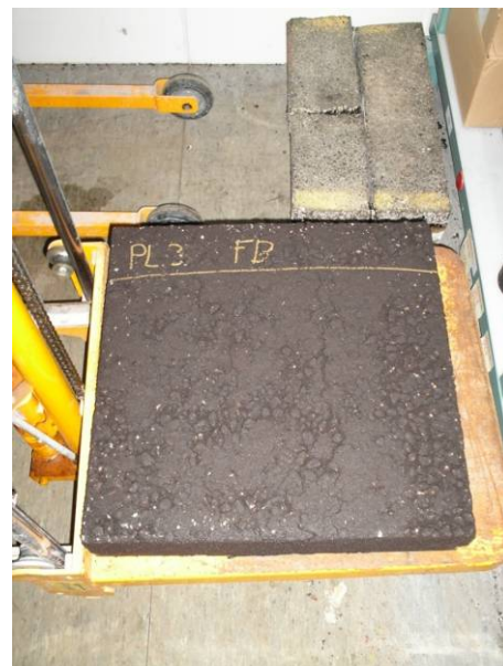
Figuur 3.20: Asfaltplaat zonder steunbak
