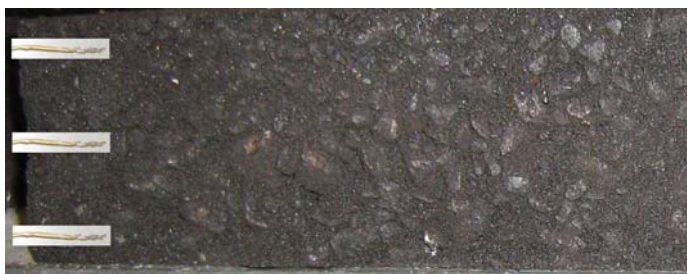
Figuur 3.4: Resultaat aanbrengen thermokoppels aan de (linker)zijkant van de asfaltlaag
