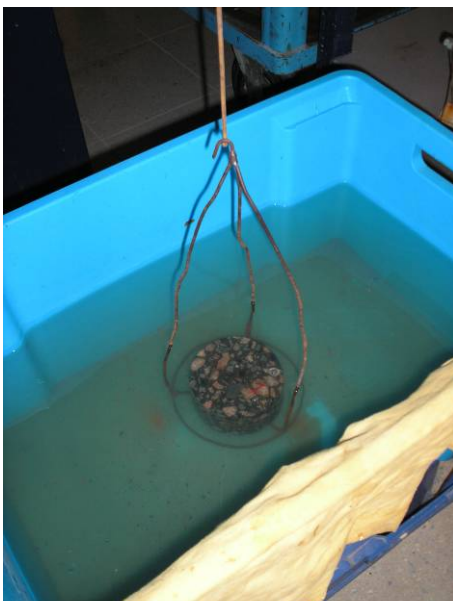
Figuur 3.25: Onder en boven water wegen
